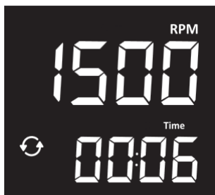
Рис. 9 – Дисплей мішалки в режимі перемішування (датчик температури не підключений, таймер вимкнений)
