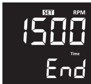
Рис. 12 – Індикація закінчення перемішування
