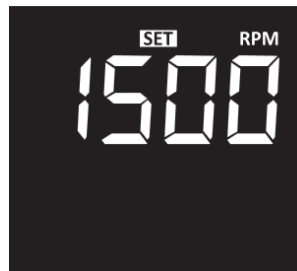
Рис. 5 – Дисплей мішалки після увімкнення живлення (датчик температури не підключений, таймер не увімкнений)
