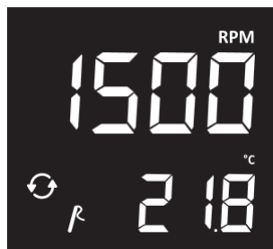
Рис. 10 – Дисплей мішалки в режимі перемішування з підключеним датчиком температури (таймер вимкнений) – температура та час перемішування відображаються послідовно
